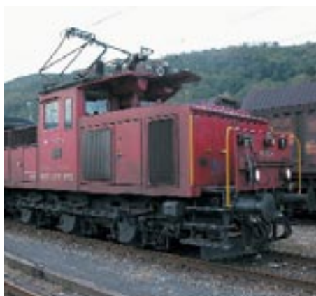
Locomotiva di manovra policorrente tipo Ee934 (Ferrovie Federali Svizzere): L'equipaggiamento elettrico di questo veicolo consente il funzionamento del medesimo sotto le reti a corrente continua 1500V e 3000V come pure con corrente alternata a 15000V 2/3 Hz e 25000V 50Hz. Queste locomotive sono utilizzate nelle stazioni di frontiera (Chiasso, Ginevra, ...)
